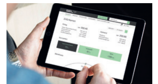
▲ Ein Blick aufs Display genügt: Grün steht für ausreichend günstiger Solarstrom vorhanden, Rot für teureren Netzstrom.
